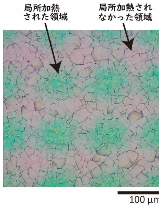
図 2. レーザーで特定の小さな場所だけを熱して作った透明磁石材料の顕微鏡写真です。レーザーを使うことで、材料の一部だけを熱し、他の部分は熱くならないようにできました。黄緑色の丸いところが、今回作った特別な材料「Ce:YIG」で、ピンクのところは Ce:YIG ができていない部分です。
