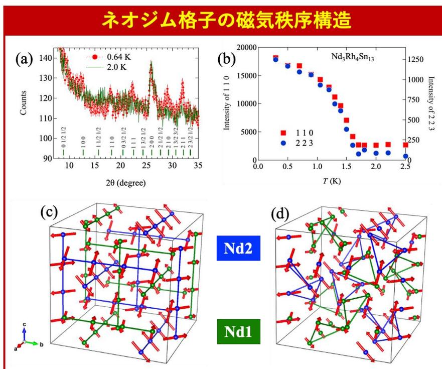
図 2 : (a) 0.64 K (約マイナス 272°C) と 2 K (マイナス 271°C) での中性子回折パターンを示す。(b) 中性子回折強度の温度依存性。1.65 K 以下で反強磁気秩序構造が生じていることを示している。(c) 中性子回折から導いた反強磁気秩序構造。ネオジムの一次元鎖で磁気モーメントは交替配列している。(d) 見方を変えると 1 次元鎖は三角格子で連結しており、磁気フラストレーション系の特徴を持っている。
