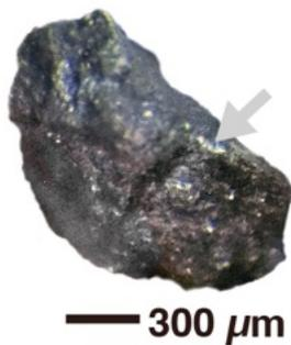
図 2：リュウグウの砂の光学顕微鏡写真。矢印はナトリウム炭酸塩脈を指す。
