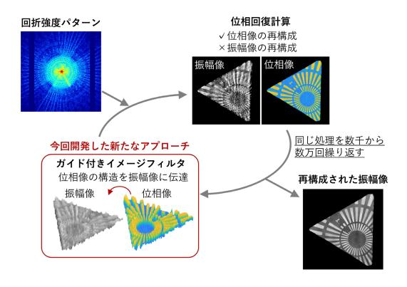
図 2. 開発手法(Phase-Guided Amplitude Reconstruction, PGAR)の流れ 一枚の回折強度パターンからでも再構成出来る位相像の構造をガイド付きイメ ージフィルタにより振幅像に伝達することで、高精度な振幅像を得ることがで きる。
