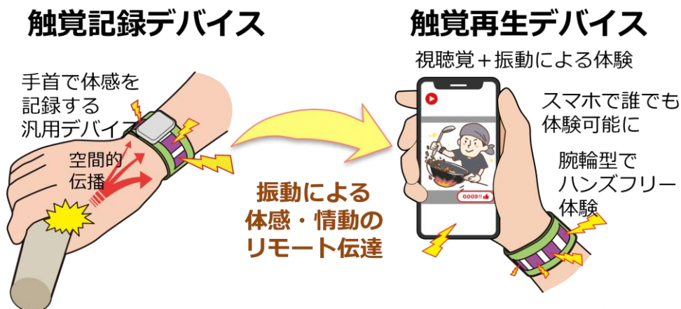
図1 双方向リモート触覚伝達システム
