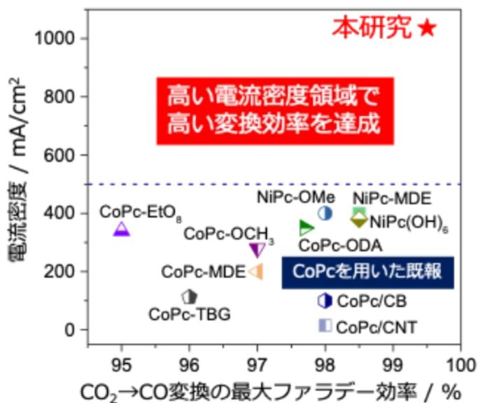
図 2. CoPc 結晶修飾ガス拡散電極と既報との CO<sub>2</sub>→CO 変換性能比較。
