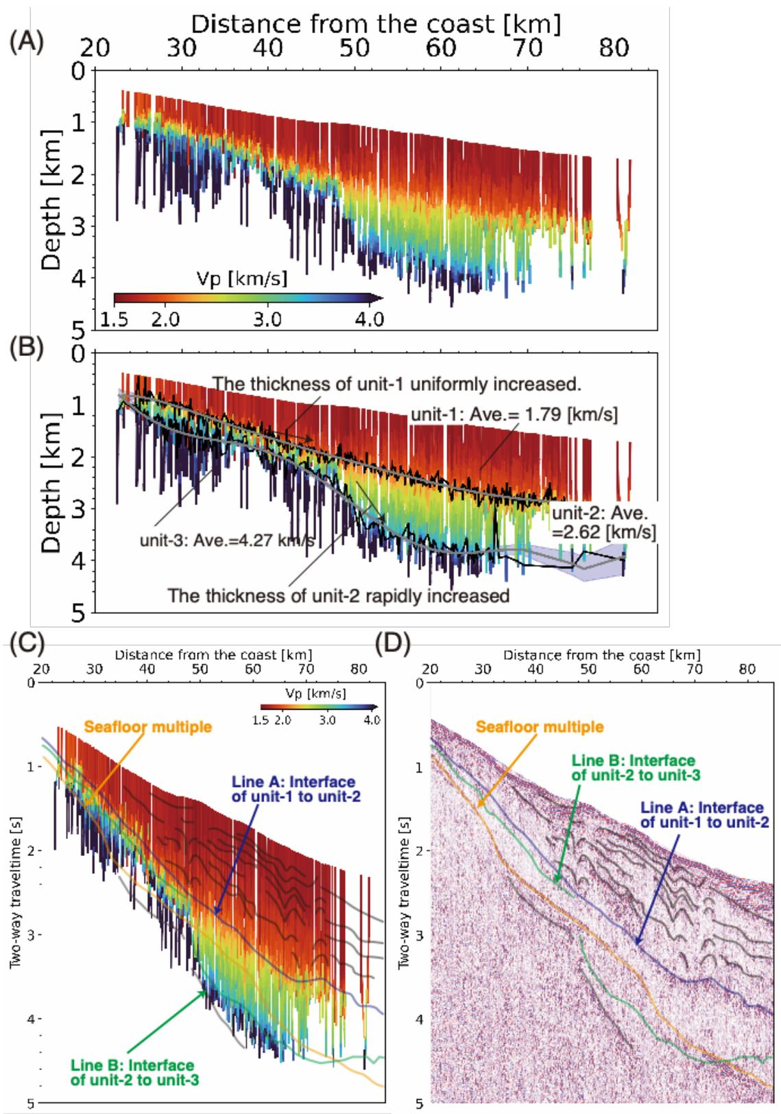
図 2. (A) の図は、「 $\tau$ -sum インバージョン法」という方法を使って推定した、地下の P 波速度構造を横方向と深さ方向の 2 次元で表したものです。これ
