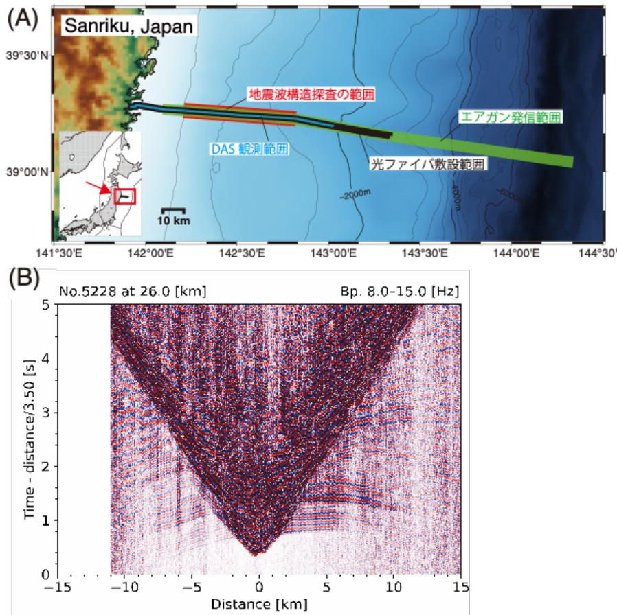
図 1. (A) この図は、本研究で行った制御地震探査の位置を示しています。黒い線は、今回の観測で使用した海底光ファイバケーブルの位置を示しており、青い線は DAS 観測を行った範囲を表しています。また、緑の線はエアガンを使って地震波を発生させた海域の範囲を示し、赤い線は、そのデータから P 波速度構造を推定した位置を示しています。
