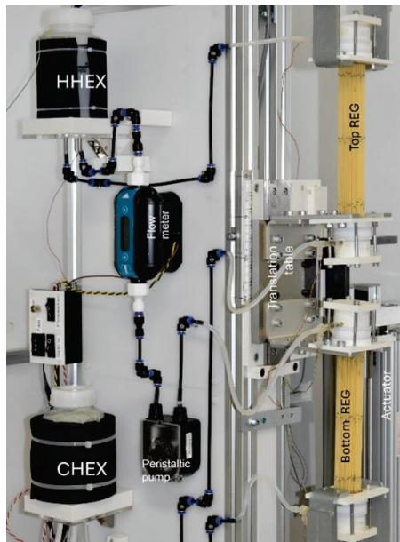
図 1. 熱－動力エネルギー変換機構の全体写真。中央の可動台の上下に天然ゴムチューブ群で構成される弾性体が配置され、両方向からの力を受ける構造となっている。この可動台は、力を測定する際にはアクチュエータに固定することが可能。
