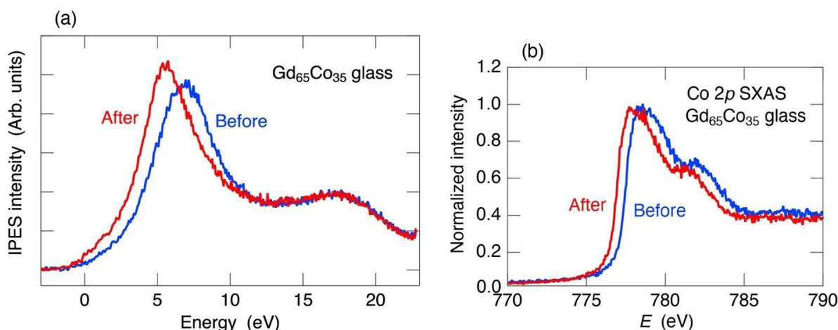
図2: 温度変化を繰り返した若返りの前(青)と後(赤)の(a)逆光電子分光スペクトルおよび(b)Co  $2p$ - $3d$  励起エネルギー付近の軟 X 線吸収スペクトル
