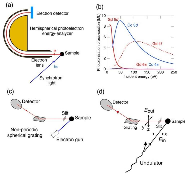
図6：電子分光の測定方法。(a)光電子分光、(c) 逆光電子分光、(d) 軟 X 線吸収および発光分光。
