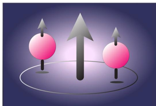
スピン三重項超伝導の概念図。中央の矢印は磁場の方向と強さを表す。磁場中で超伝導はその状態を柔軟に変え、より強い磁場に適応した新しい状態へ自ら移行する
