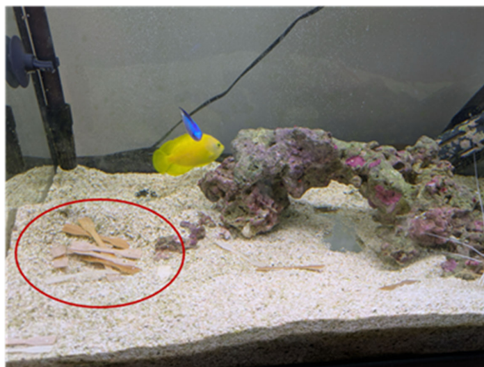
図 5. 海水環境における曝露試験の様子。海水魚を含む水槽内で竹-PHBH 複合材料を長期間曝露し、海洋環境を模擬した条件下で劣化挙動を評価。
