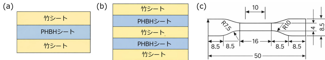
図1. 竹-PHBH 複合材料の積層構造と試験片形状。竹シートとPHBHシートを積層した (a) P1B2 および (b) P2B3 構成の模式図と、(c) 引張試験片の形状。
