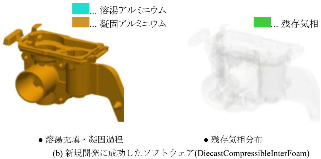
図 1. 鋳造解析専用ソフトウェア開発の変遷（溶湯混相流体の圧縮性を考慮し、凝固過程をシミュレート可能なソフトウェア開発に成功した）
