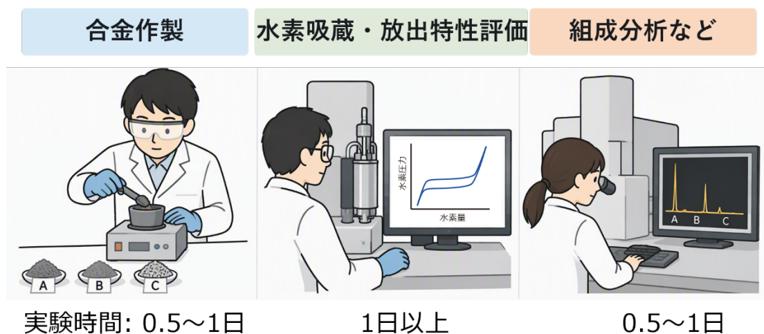
図 1. 従来の水素吸蔵合金探索実験
