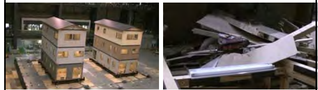
3階建て軸組構法住宅の倒壊実験
