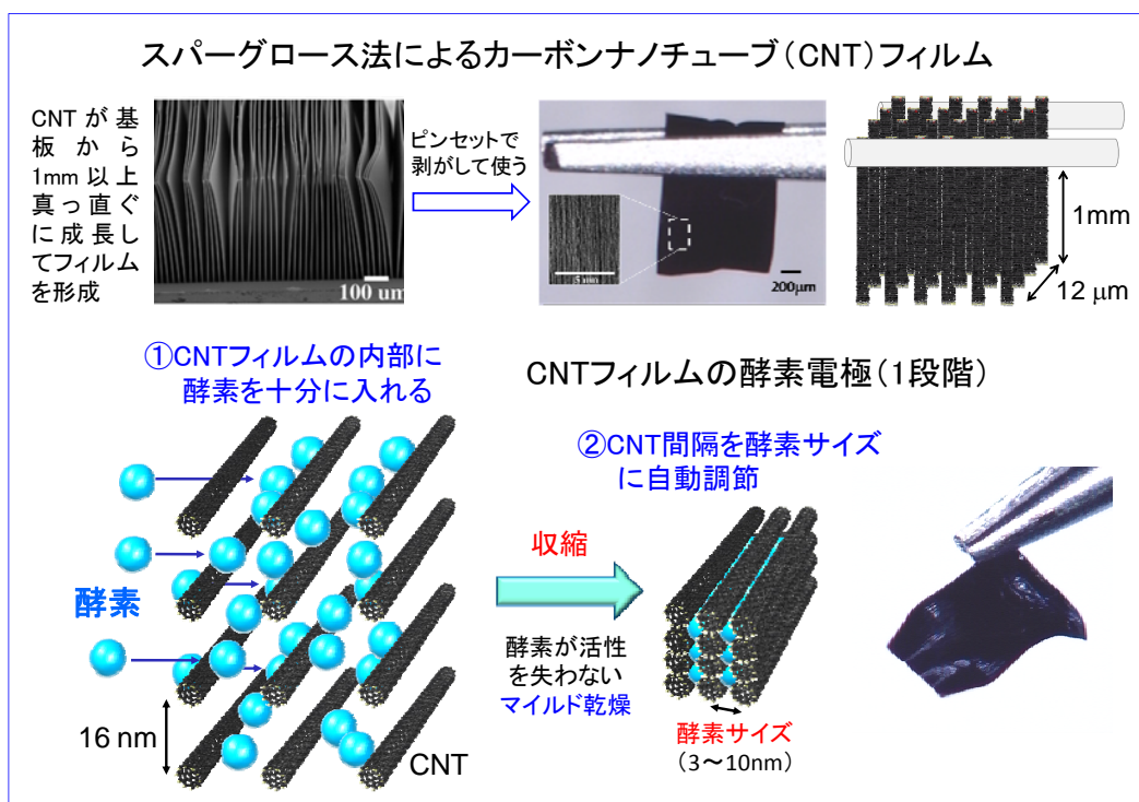
図2 CNTフィルムの構造と酵素の固定プロセス
