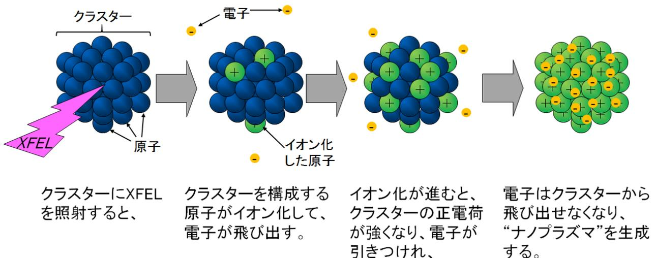
図 1. クラスターがナノプラズマ化する仕組みの概念図
