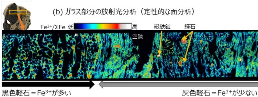
図 2 放射光分析によって軽石を構成する火山ガラス中の鉄の 2 価・3 価の比を決定。(a) 代表的な点のスポット分析により  $\text{Fe}^{3+}$ /全 Fe の割合を具体的に決定すると、黒色軽石部の方が  $\text{Fe}^{3+}$  が高い。(b) また、定性的に広い範囲での  $\text{Fe}^{3+}$ /全 Fe の値を調べると、やはり黒色軽石部分で全体的に  $\text{Fe}^{3+}$  が高かった。
