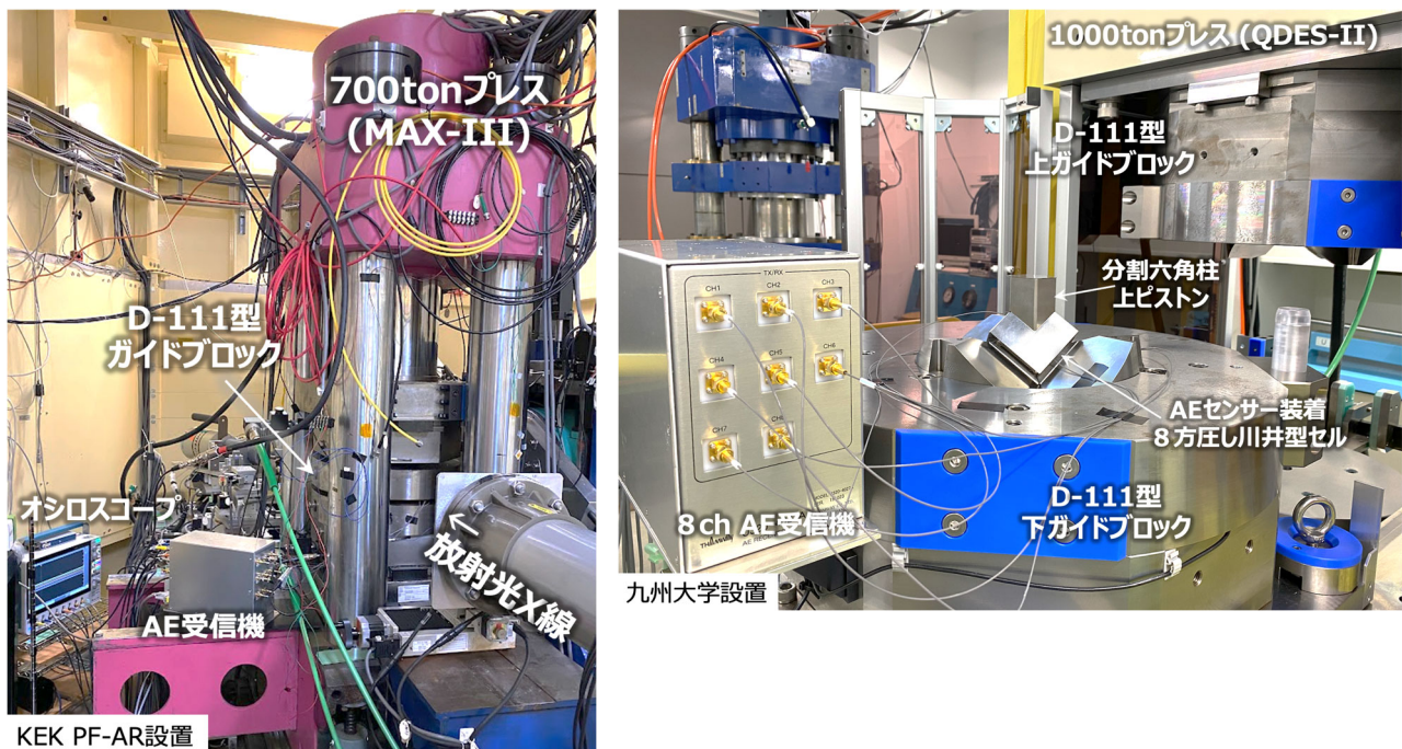
（図2）D-111 型高圧変形装置と AE 測定システム
