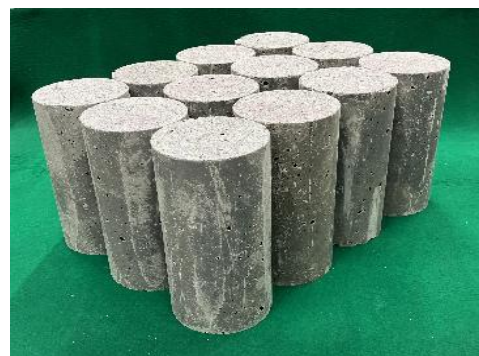
炭酸化スラグを用いた環境配慮型コンクリート
