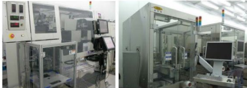
ダイレベル加工/C2W & W2W接合/研磨等 2, 4, 6, 8 12インチ装置群
