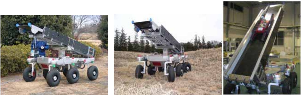
図2 今回開発した親ロボット（伸展式の梯子の上に子ロボットを2台搭載する）
