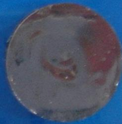
直径 30mm の  $Zr_{55}Cu_{30}Ni_5Al_{10}$  バルク金属ガラス
