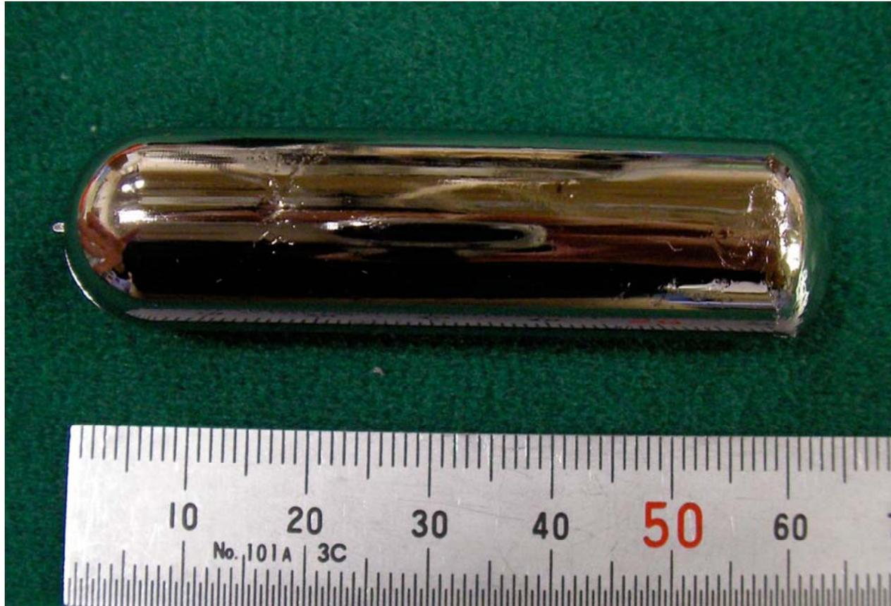
吸引鑄造法を改良・発展させた傾角鑄造法を用いて作製
